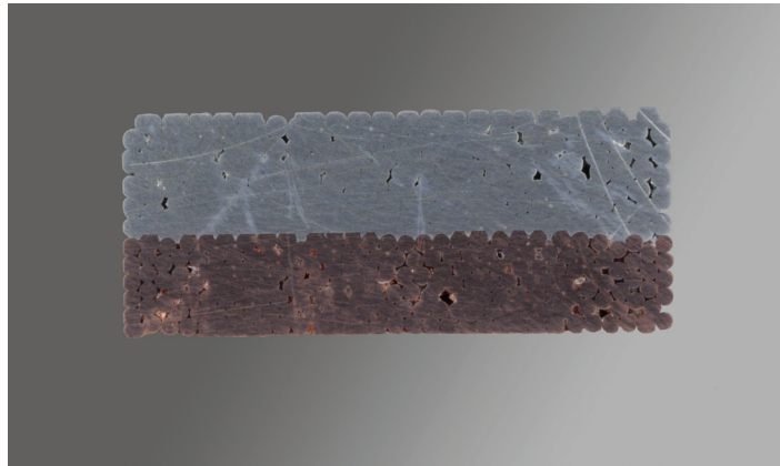
Querschliff einer Kaskade (Aluminium-Kupfer-Verbindung)
