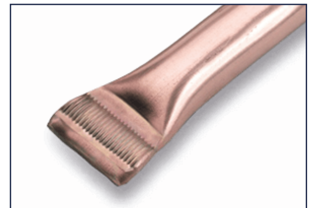
Im Bereich Kühltechnik werden Kupferrohre mit Ultraschallschweißmaschinen abgeschnitten und gasdicht verschweißt, sodass der Kältekreislauf hermetisch verschlossen ist.
