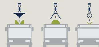
Das 4-polige System sorgt für eine konstante Anpresskraftverteilung auf alle vier Stromschielen und gleicht Fahrzeugbewegungen während des Nachladens zuverlässig aus.
