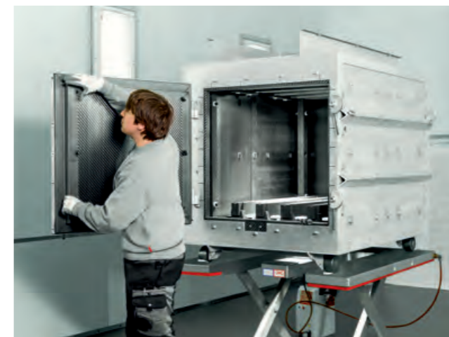
Fachgerechter Reline-Service an einer Hot Zone
