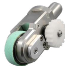
^ Patentierte Korrekturtechnologie für optische Flächen wie Kameralinsen
