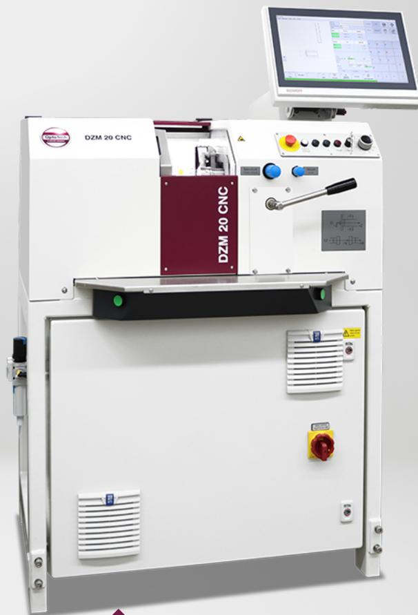
Die kompakte CNC-gesteuerte Zentriermaschine DZM 20 CNC eignet sich speziell für Bauteile im Bereich Super-Mikro und Endoskopie. Das Spannen der Linsen erfolgt im Glockenspannverfahren oder Steckzentrierverfahren (HD12).
