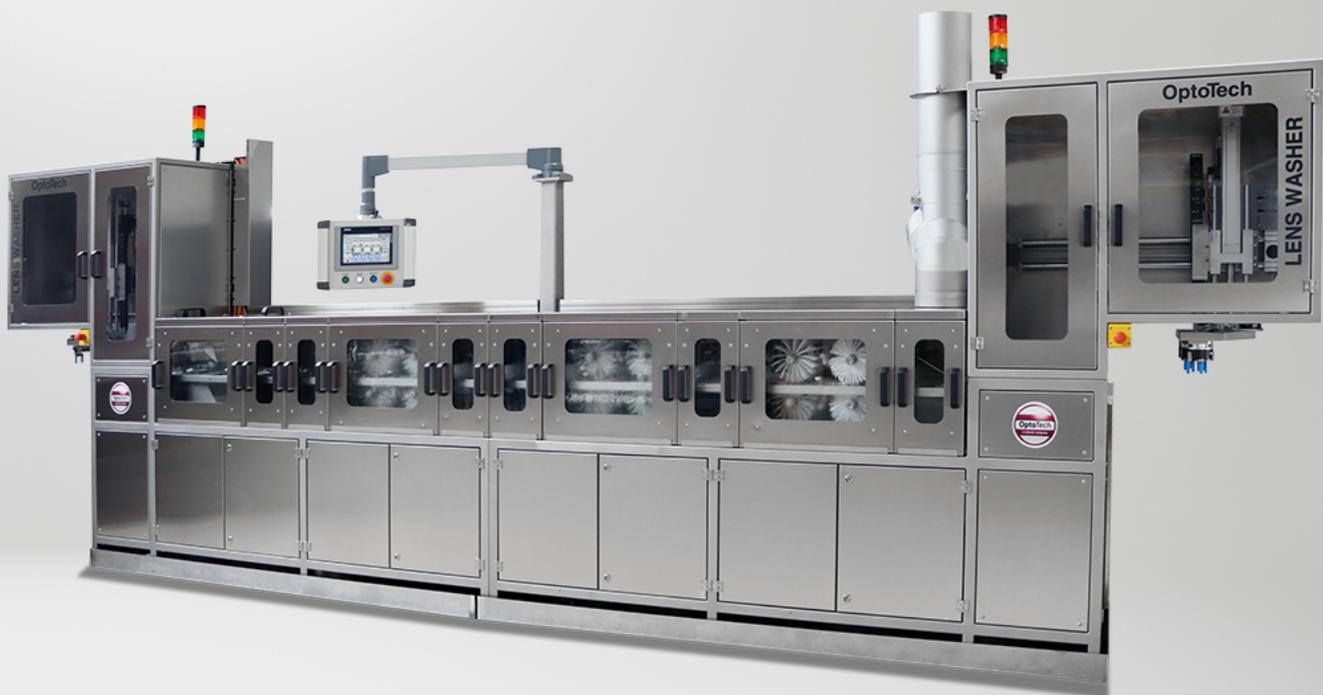
Der Lens Washer ist eine vollautomatische Anlage zur Reinigung von Brillengläsern und Sonnenschutzgläsern aus Kunststoff und Mineralglas sowie Casting Molds aus Mineralglas. Klebstoff-, Polier- oder Schmutzrückstände und Fingerabdrücke auf der Glasoberfläche werden zuverlässig entfernt.
