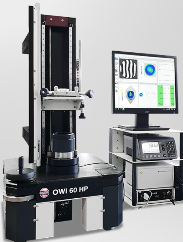
Die kompakten Fizeau Werkstattinterferometer OWI 60 HP und OWI 60 HP Invers sind ideale Geräte für das Vermessen von optischen Bauteilen. Zahlreiche Optionen ermöglichen die Anpassung der Messgeräte an individuelle Messaufgaben.
