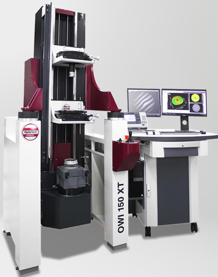
Hochpräzises Fizeau-Werkstattinterferometer für das Prüfen von sphärischen und asphärischen Bauteilen. Eine hochgenaue Kinematik und ein Messstrahldurchmesser bis zu  $\varnothing$  150 mm machen dieses Messgerät zu einem unentbehrlichen Werkzeug für die Fertigung von Hochleistungsoptiken.
