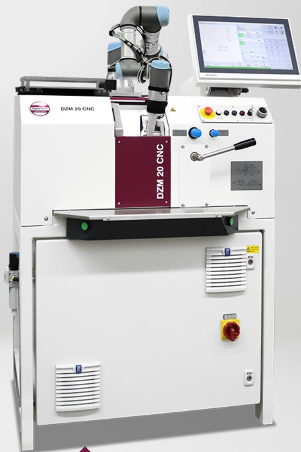
Der OptoTech SR 20 ist eine voll integrierte und kompakte Roboterlösung für automatisiertes Be- und Entladen der OptoTech Zentriermaschinen DZM 20 CNC und WZM 20 CNC. Ein speziell konzipiertes Vakuumgreifer-System ermöglicht das Handling kleinster Linsen aus dem Bereich Mikro-Optik und Endoskopie.
