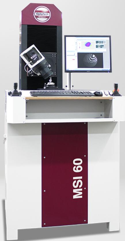
Multifunktionelles Stitching Interferometer zum Prüfen von hochaperturigen Sphären bis Durchmesser 100 mm.
