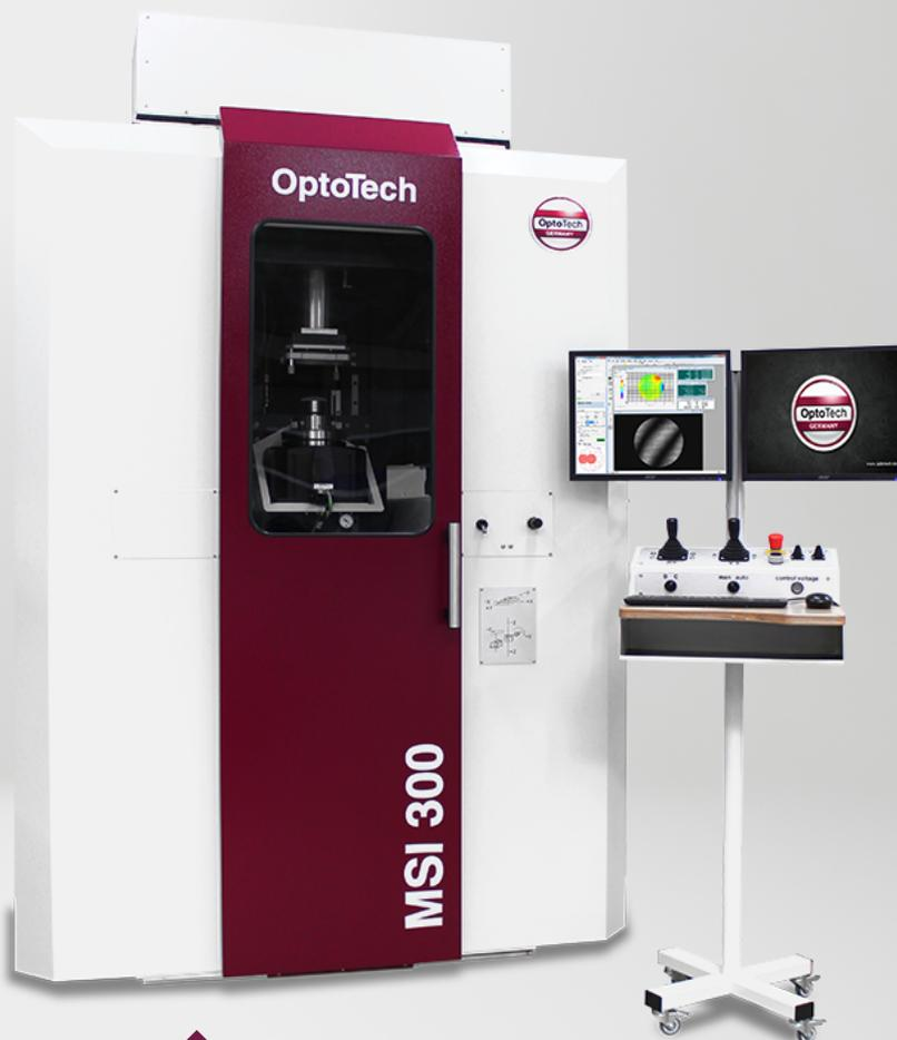
Multifunktionelles Stitching Interferometer zum Prüfen von hochaperturigen Sphären bis  $\varnothing$  300 mm.
