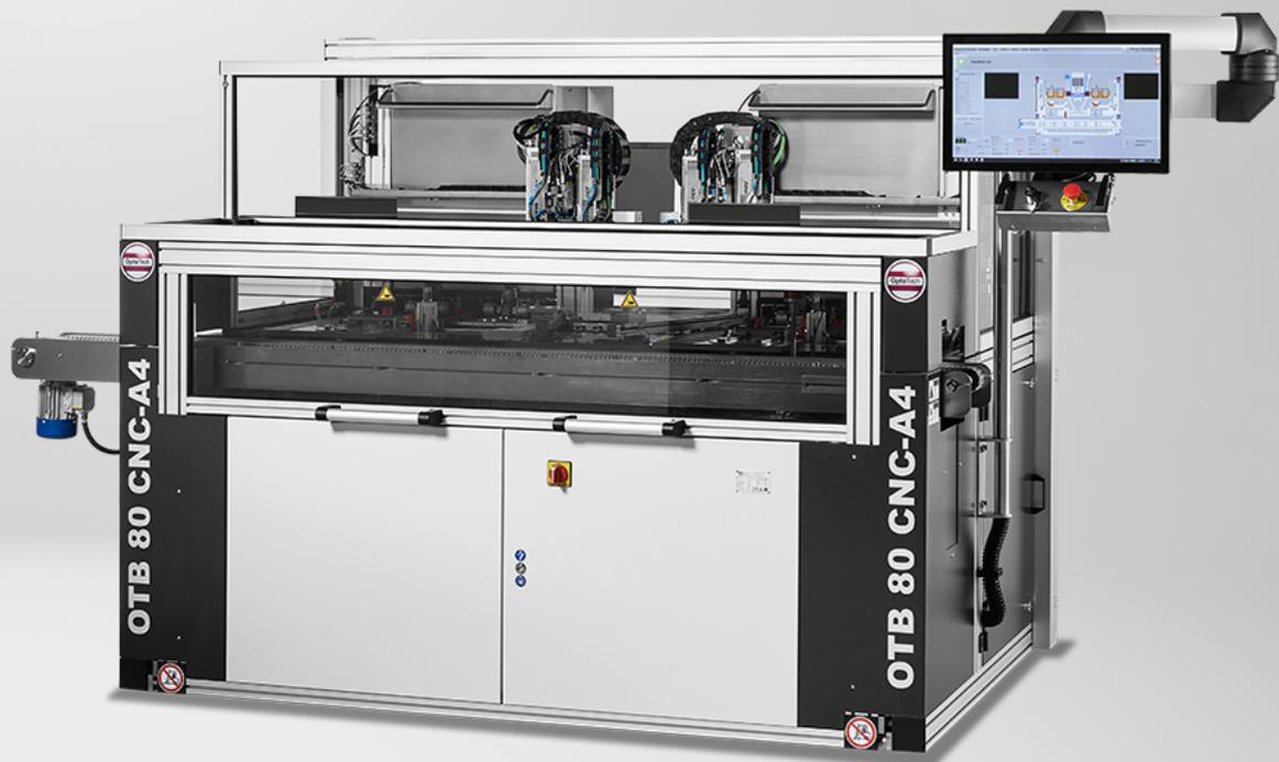
Der neue Autoblocker OTB 80 CNC-A4 ist der ideale Alloy-Blocker für Großserienfert. Mit 4 Block-Stationen und einer Leistung von bis zu 240 Gläser pro Stunde ist der OTB 80 CNC-A 4 der schnellste Alloy-Blocker im Markt der Markt.
