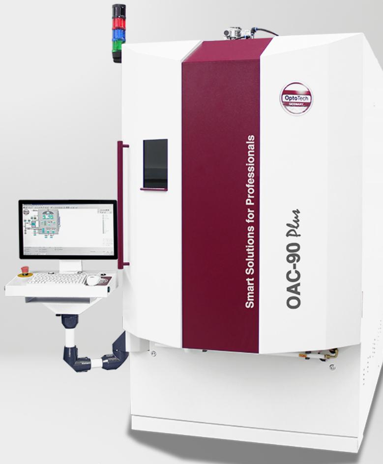
Die OptoTech's Beschichtungsmaschine OAC-90 Plus wird zum Auftragen von hochwertigem Antireflex-Beschichtungen (AR) und sogenannten Clean Coats (CC) auf ophthalmischen Linsen verwendet. Das OAC-Beschichtungssystem zeichnet sich durch die für OptoTech bekannte Produktqualität, einfache Handhabung und Zuverlässigkeit im täglichen Produktionsbetrieb aus.
