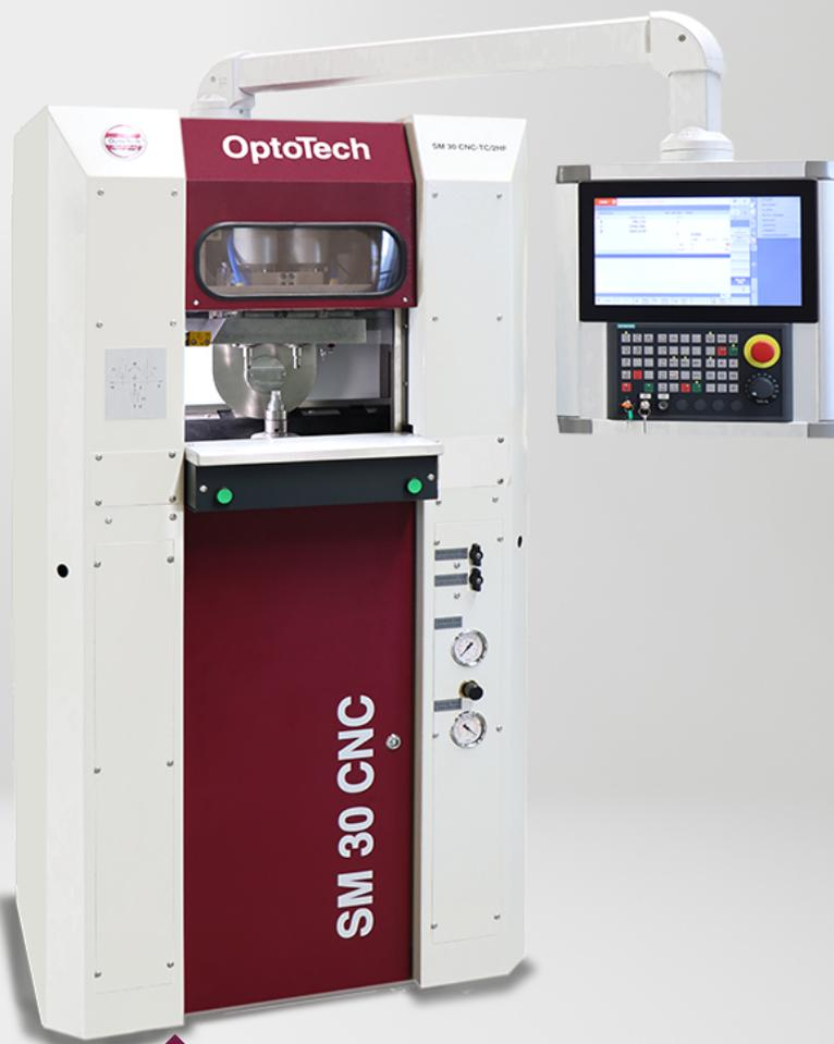
Die Schleifmaschine SM 30 CNC-TC mit 2 Schleifspindeln ist die ideale Low Cost Variante einer Hochgeschwindigkeits CNC Schleifmaschine für die Bereiche Supermikro und Endoskopie. Der universelle Arbeitsbereich, die einfache Bedienung in Verbindung mit modernster Schleiftechnologie mittels Standard Topfschleifwerkzeugen sowie das Preis-Leistungsverhältnis dieser Maschine wird Sie begeistern.
