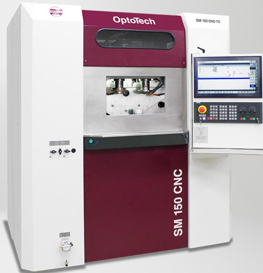
Die OptoTech Präzisionsschleifmaschine SM 150 CNC-TC ist ideal geeignet für den flexiblen und universellen Einsatz zur Fertigung von sphärischen Bauteilen. Sie ist die ideale Ergänzung zur Poliermaschine SPK 150 CNC - Für ausgeglichene Zykluszeiten von Schleifen und Polieren. Eine CNC-Bearbeitungslinie besteht somit nur noch aus 2 Maschinen ohne Wartezeiten.
