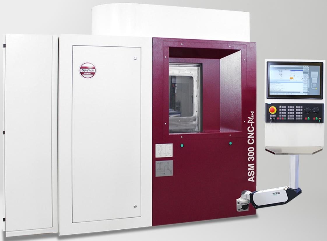
Die 4-Achsige ASM 300 CNC-Plus ist eine der weltweit genauesten Vor- und Feinschleifmaschinen für Asphären und Freiformflächen. Durch hydrostatische Lagerung aller Achsen in Verbindung mit einer hochwertigen Asphärensoftware fertigt die ASM 300 CNC-Plus Flächen in höchster Präzision. Durch die Interpolation von nur 2 Achsen beim Schleifen entsteht eine hochfeine Oberfläche.
