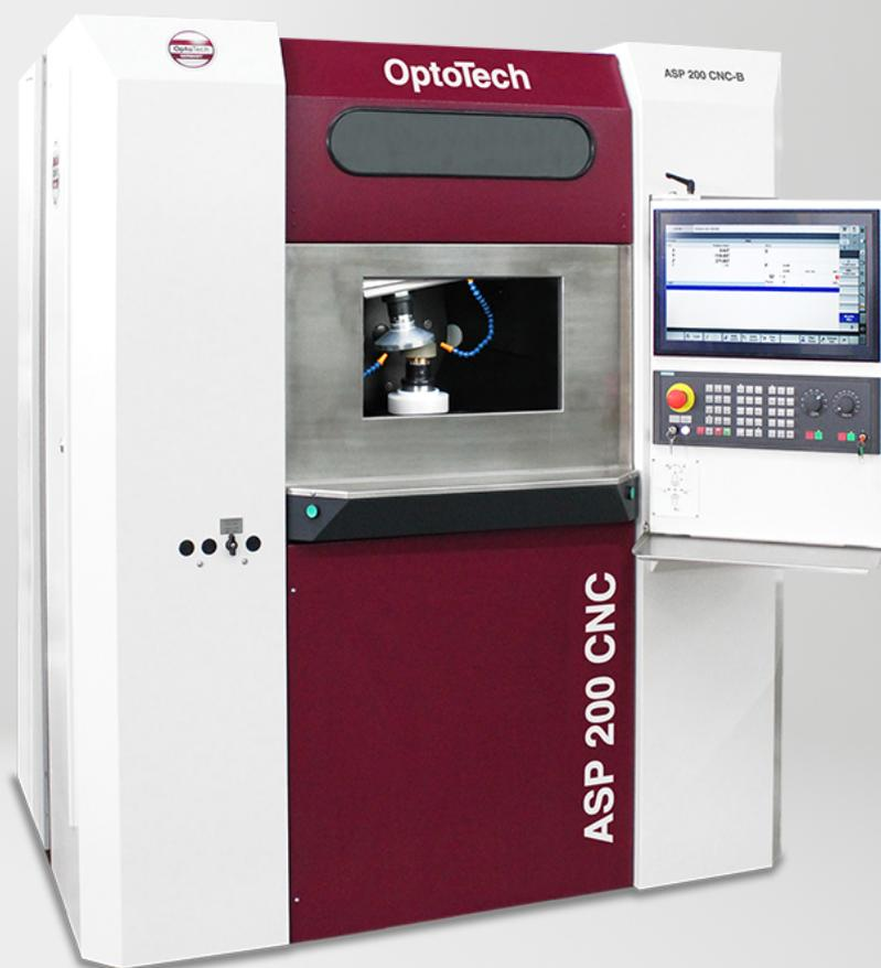
Die OptoTech 4-Achs Poliermaschine ASP 200 CNC-B ist eine einfache, aber universell einsetzbare Poliermaschine für Sphären und Asphären bis hin zu 3D-Flächen.
