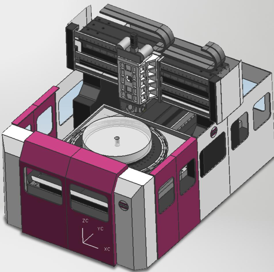
Die neue Ultrapräzisions-Schleifmaschine UPG 1500 CNC wurde speziell zur Herstellung von bis zu 1,5m Durchmesser großen Astro-Optiken entwickelt. Ob Sphären, Asphären oder Freiformflächen, die Maschine bietet Ihnen höchste Präzision beim Schleifen in Kombination mit einer integrierten hochgenauen Messtechnik. Typische Anwendungsbereiche sind Astronomie und Weltraumforschung, Luft- und Raumfahrt, Halbleiterindustrie, SiC-Verarbeitung und andere Bereiche der Hochpräzisionsoptik.
