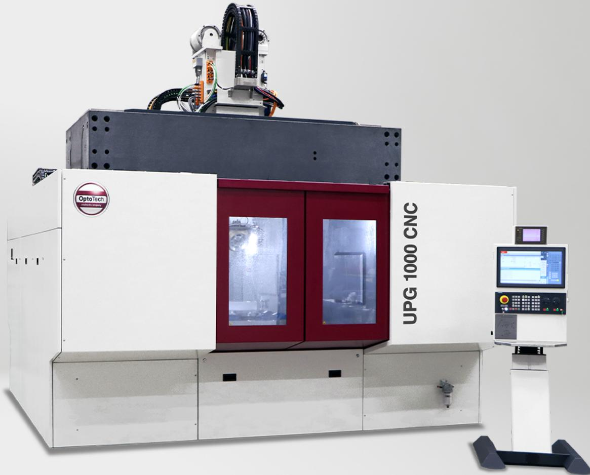
Die neue Ultrapräzisions-Schleifmaschine UPG 1000 CNC wurde speziell zur „cut to polish“ Komplettbearbeitung von bis zu 1m Durchmesser großen Astro-Optiken entwickelt. Ob Sphären, Asphären oder Freiformflächen, die Maschine bietet Ihnen höchste Präzision beim Schleifen in Kombination mit einer integrierten hochgenauen Messtechnik. Dieser kompakte und hocheffiziente Aufbau ermöglicht es alle wichtigen Zukunftsbauteile im Bereich ASTRO-Optik, EUV-Optik sowie Weltraumtechnik optimal zu fertigen.
