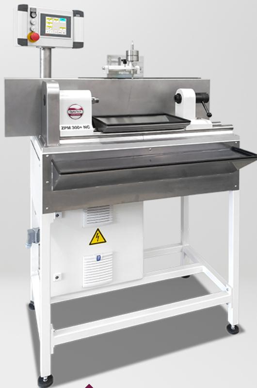
Die NC-gesteuerte Zylinderpoliermaschine ZPM 300+ NC ist eine Spezialmaschine zum Schleifen und Polieren von Zylinderlinsen und Stäben mit kleinen Radien. Die einfache und hocheffiziente Kinematik ermöglicht eine Fertigung in höchster Präzision.
