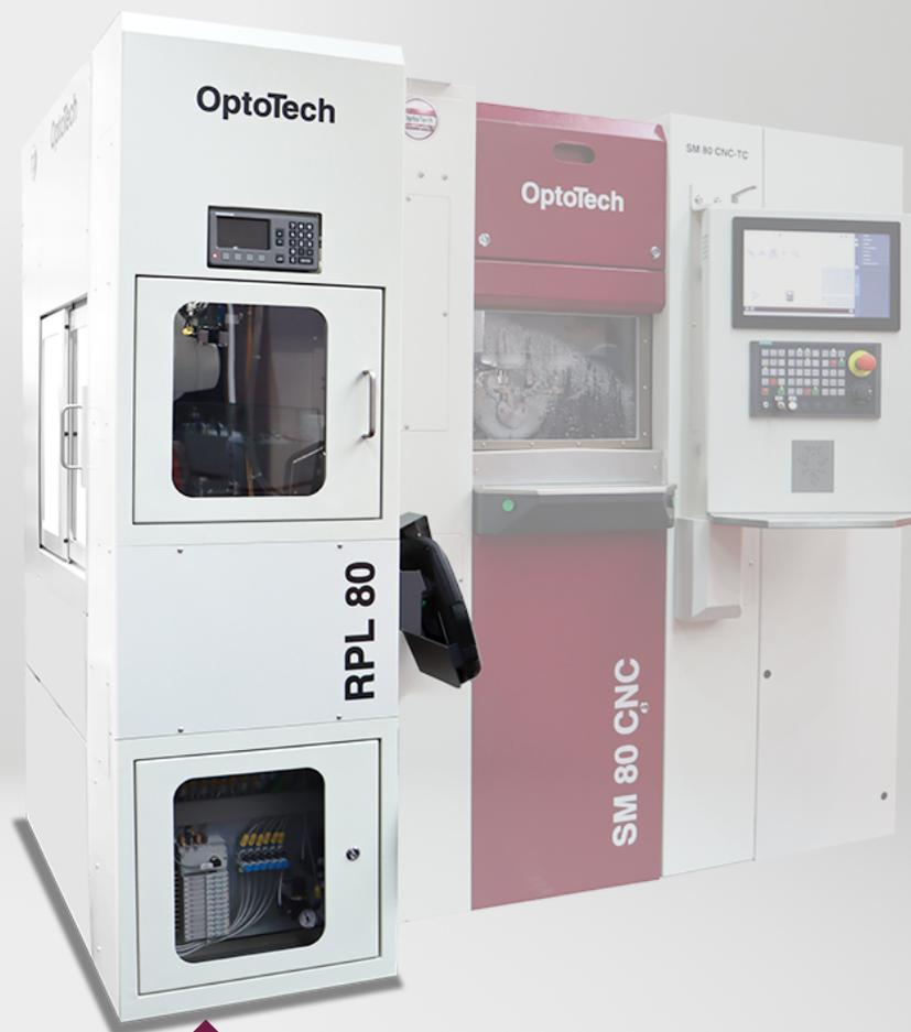
Der RPL 80 ist die leistungsstarke Roboterlösung von OptoTech, die das automatische Be- und Entladen der Schleifmaschine SM 80 CNC-TC, der Poliermaschine SPK 80 CNC sowie des Interferometers OWI 60 HP Invers-A ermöglicht. Der RPL 80 kann sowohl Einzelflächen (bis Ø80mm) als auch Linsen auf Kittstücken befördern.
