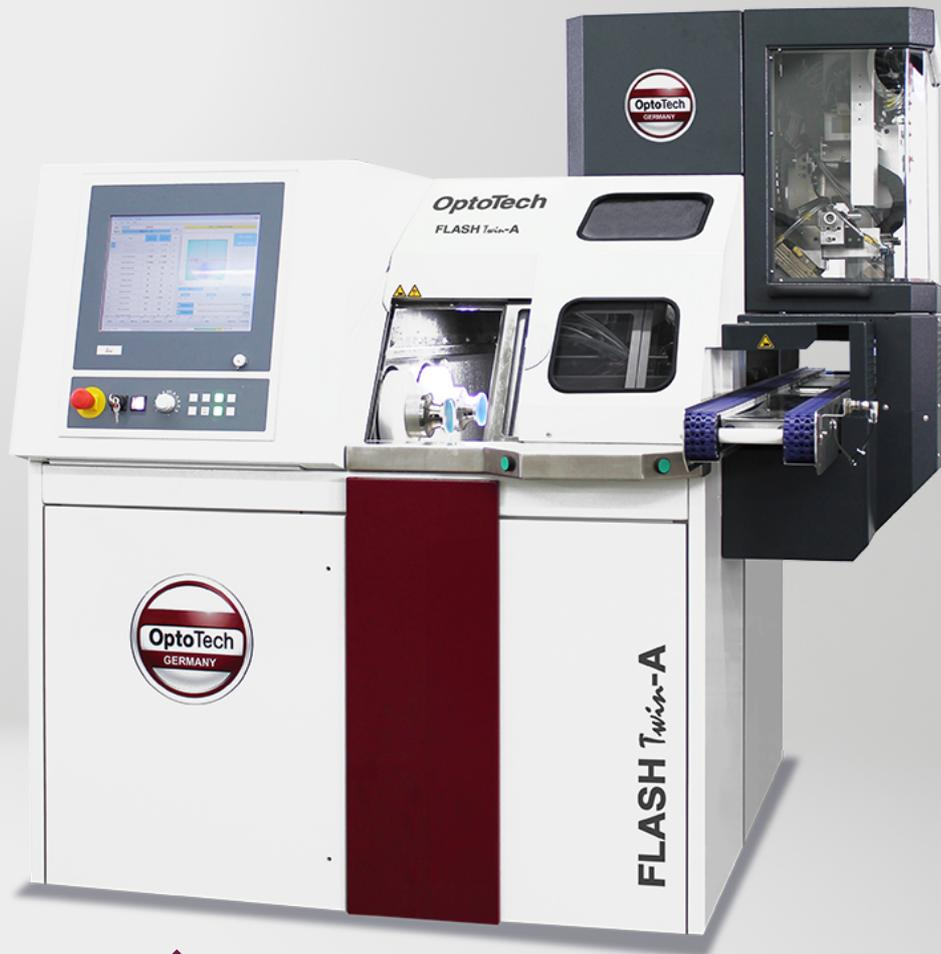
Die neue digitale Plandrehmaschine FLASH Twin-A ist eine Weiterentwicklung unserer bewährten FLASH-Serie. Durch die Verwendung von 2 Fast Tools ist die FLASH Twin-A in der Lage, 2 Freiform Brillengläser gleichzeitig zu verarbeiten. Eine erhöhte Drehzahl der Werkzeugspindeln, kombiniert mit erstklassiger Präzision-Kugellager, führt zu deutlichen Qualitäts- und Quantitätsverbesserungen. Die Maschine ist die ideale Ergänzung zu unserer ESM Twin-A.
