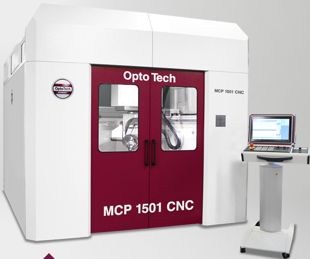
Die MCP 1501 CNC ist eine hochmoderne Maschine für komplexe Polieraufgaben. Sphären, Asphären und 3D-Flächen können in höchster Präzision bearbeitet werden. Das innovative Multitoolkonzept bietet optimale Verfahrenstechnik. Leistungspolitur und Korrekturpoliertechnologie integriert in einer Maschine.
