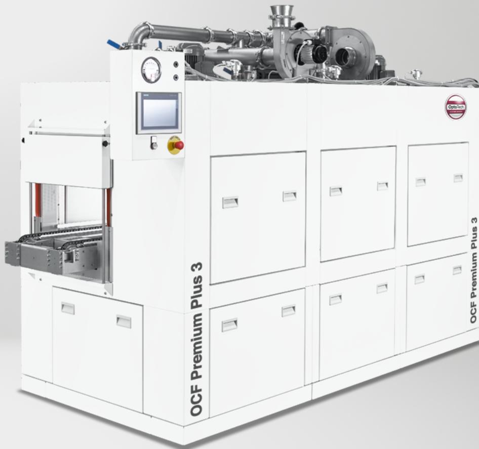
Der OCF Premium Plus 3 wurde speziell für die Aushärtung von Beschichtungen auf Brillengläsern in einem kontinuierlichen Durchlaufofen unter Reinraum-Bedingungen nach dem Hardcoating-Prozess konzipiert. Das modulare System verfügt über 3 individuell geregelte Heizzonen, deren Arbeitstemperatur unabhängig voneinander eingestellt werden kann und somit maximale Prozessflexibilität bietet.
