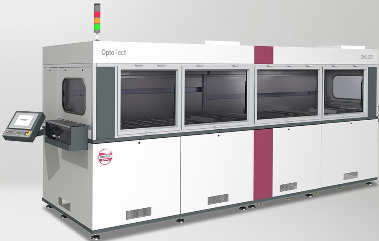
Die OptoTech Hard Coating Systems (OHC) kombinieren Reinigung mit Ultraschall und thermischer Tauchbeschichtung für ophthalmische Linsen. Die OHC-Hartbeschichtungsanlagen zeichnen sich durch die von OptoTech bekannte Produktqualität OptoTech bekannt ist, einfache Handhabung und außergewöhnliche Zuverlässigkeit im täglichen Produktionsbetrieb aus. Unsere Hartbeschichtungssysteme nutzen bewährte Technologien, um makellose und kontaminationsfreie Brillenglasoberflächen zu erzeugen.
