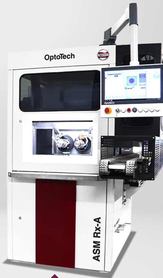
Die ASM Rx-A ist die ideale universelle 4-Achs Schleifmaschine für mineralische Brillengläser. Kugeln, Asphären, torische, A-torische bis hin zu Freiformflächen können in höchster Präzision und Genauigkeit hergestellt werden. Die Maschine bietet ein qualitativ hochwertiges Schleifen durch 2 interpolierende Achsen.
