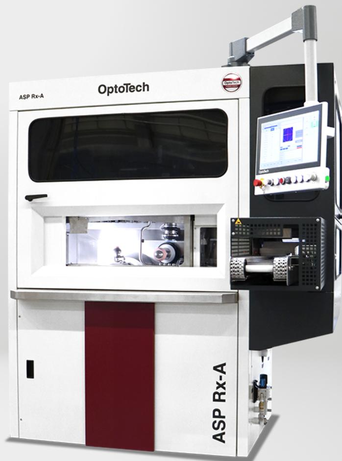
Der OptoTech Digital-Surfacing-Polisher ASP Rx-A ist für das vollautomatische Hochgeschwindigkeitspolieren von torischen/atorischen oder rückseitig-progressiven Mineralgläsern. Runde, ovale oder Linsen jeder anderen Form können poliert werden.
