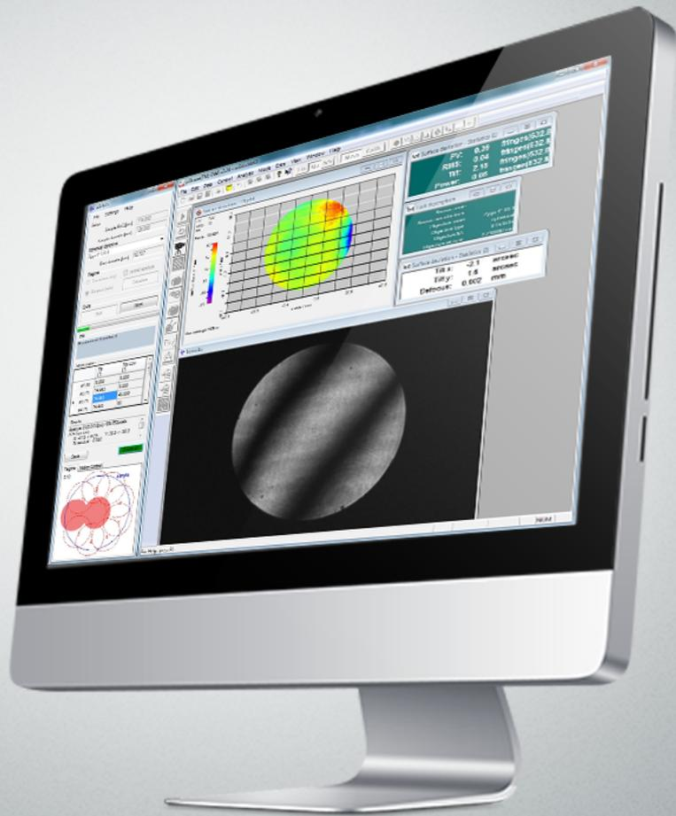
$\mu$ Stitch ist eine Stitchingsoftware und wird in Verbindung mit  $\mu$ Shape verwendet (Add-On) für unsere Interferometer der MSI Baureihe. Sie ermöglicht über ein Stitching die Messung der gesamten Oberfläche von sphärischen (Form- & Radienfehler) und planen (Formfehler) Optiken, die aufgrund ihrer Abmessungen nicht in einer Einzelmessung erfasst werden können.
